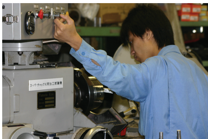
チャック開発専用機による精度確認作業
